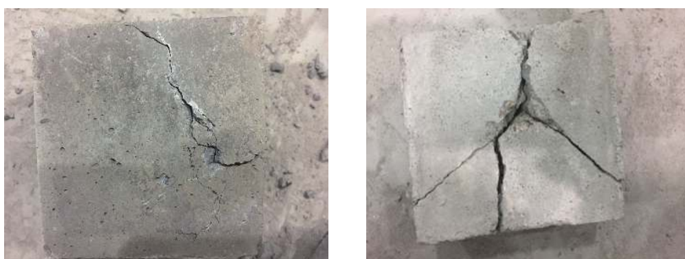
图 5 超声动态载荷试验与裂纹分布
