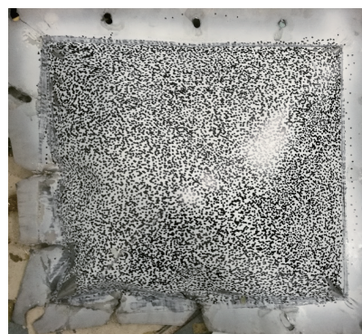
图 5 TC4 钛合金平板破坏照片
