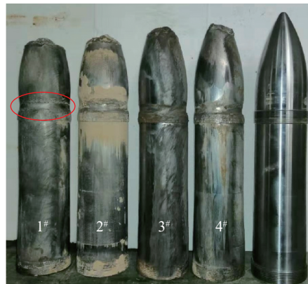
图 6 实验前后弹体外观比较
