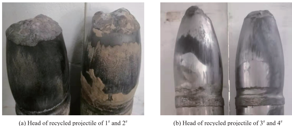
图 7 回收弹体头部侵蚀破坏
