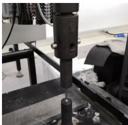
图 4 圆柱试件加持状态照片
