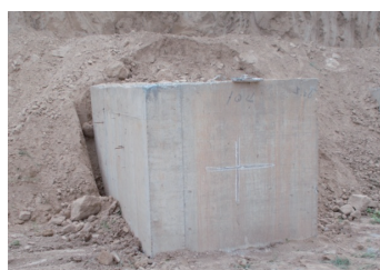
图 2 实验钢筋混凝土靶
