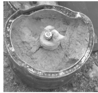
图 3 实验后的弹体变形型面 Fig. 3 Final deformation shape after experiment
