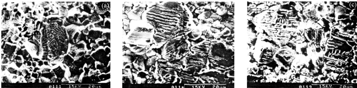
图 5 不同状态下 PZT-95/5 陶瓷材料的电畴分析结果
