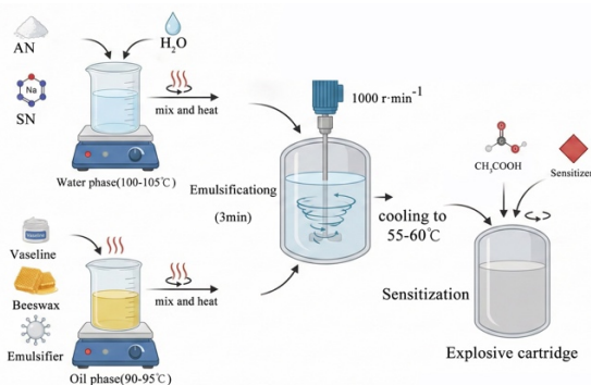
图 1 乳胶基质制备示意图
