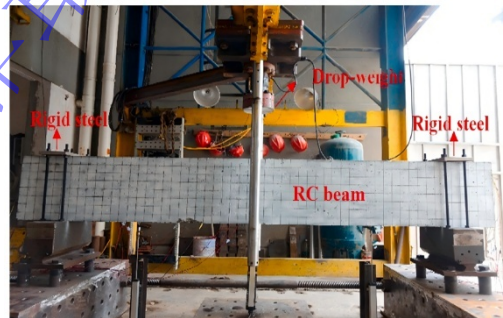
图 2 RC 梁冲击装置 [18]
