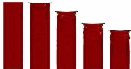
图 13 III 型梁的变形过程
