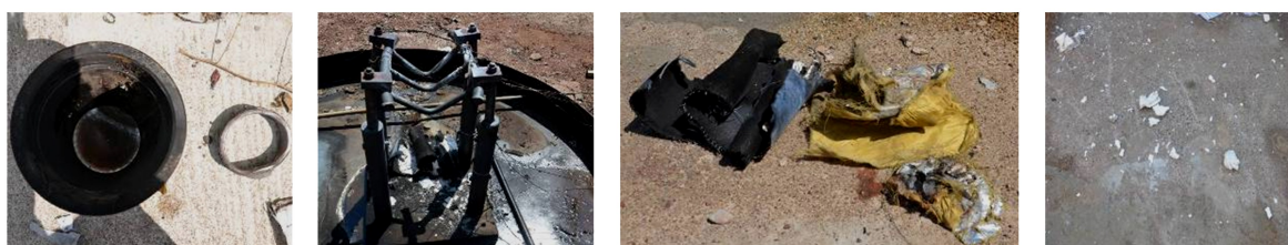
图 11 包覆隔热弹衣试验件破坏状态
