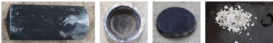
图 5 试验件破坏状态
