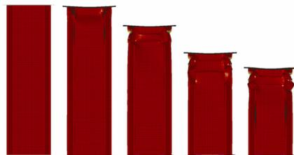
图 13 III 型梁的变形过程
